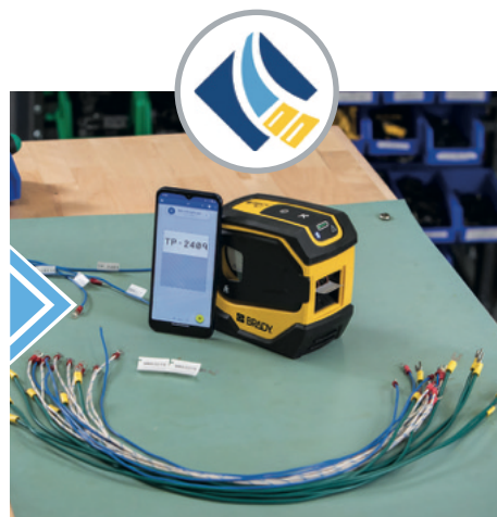
Etiketten werden direkt am Einsatzort gedruckt.
